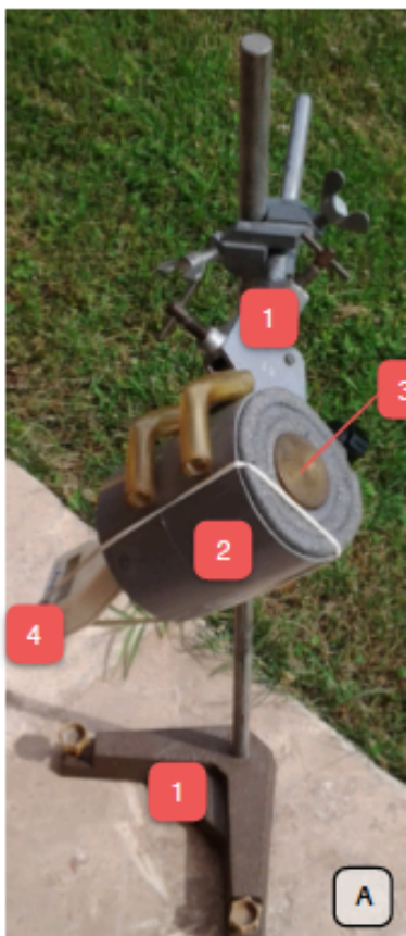
FIGURE 1 : Mesure de la constante solaire.
